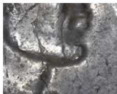
图 35 钱币正面底板的挤压痕，根据花押左上部的存留，可见面部部长方形为原币突出的图案部分
