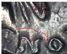
图 34 钱币正面底板上的花押挤压痕
